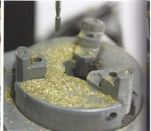
Für das Verzieren des Uhrwerks, etwa durch Perlieren oder den Genfer Streifen, kommen Maschinen zum Einsatz.
