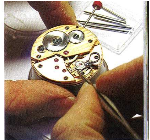
Unitas 6497 oder 6498 heißen die Uhrwerke, die in Telgte veredelt werden.
